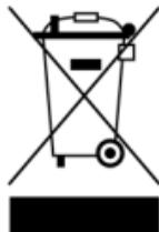
Бұл белгілер құрылғыны, оның аккумуляторлары мен аккумуляторларын, сондай -ақ оның электрлік және электронды керек -жараптарын қоқысқа тастау кезінде электрлік және электронды қондырылардың қалдықтарын (WEEE), батарея мен аккумулятор қалдықтарының ережелерін сақтауды білдіреді.
