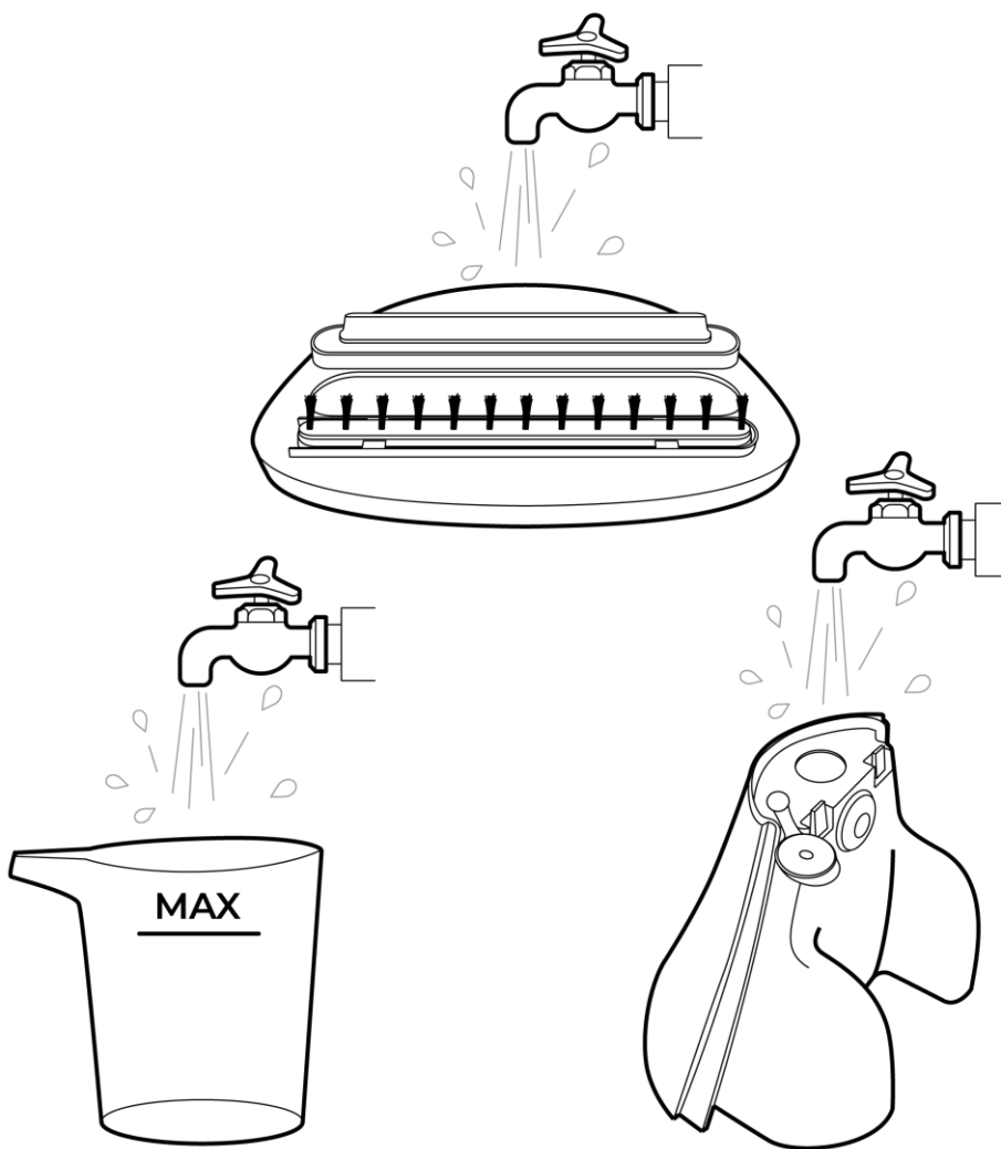
Rysunek 19 – Czyszczenie zbiornika wody i akcesoriów
