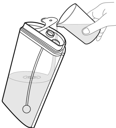
Рисунок 7 – Наполнение резервуара водой
